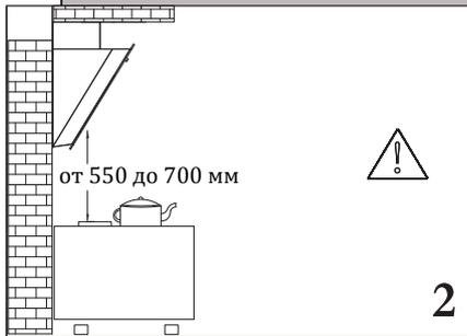
Рекомендованное расстояние между вытяжкой и варочной панелью от 550 мм ( для газ. панели от 650 мм) до 700 мм.
