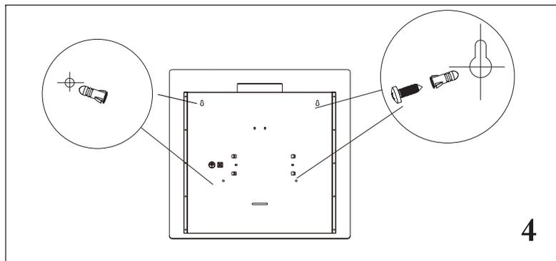
В соответствии с картинкой 4 расположите 4 отверстия для крепления вытяжки. Затем просверлите 4 отверстия, диаметром 8 мм. Используйте дюбели и саморезы из комплекта поставки.
